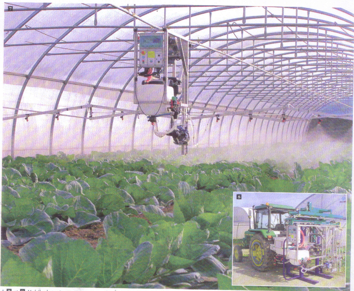
▲ 7 et 8 Mobile de traitement autonome des Éts Lapeyre François construction mécanique automatisme (11). Accrochage au rail de la serre. Plusieurs modes de transport : sur une roue automotrice ou non, sur tracteur (châssis fixé à l'attelage 3 points), sur élévateur (adaptation sur les fourches). Largeur de rampe : 6 à 10 m, ajustable à souhait suivant la demande. Vitesse programmable jusqu'à 4 km/h (photos Éts Lapeyre François).
